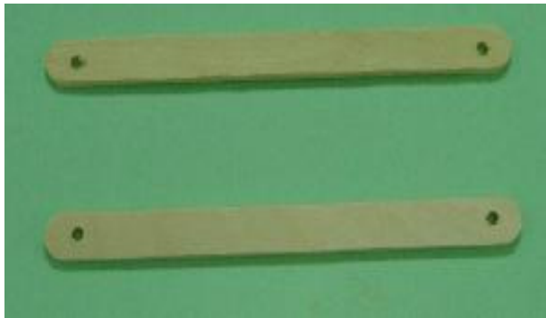
手搖鑽鑽孔製作 連桿
