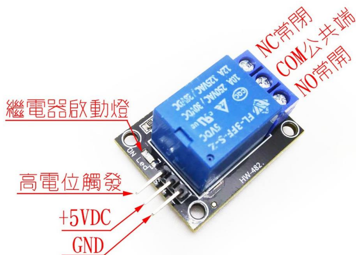
圖三：繼電器模組（HW-482）接線圖
