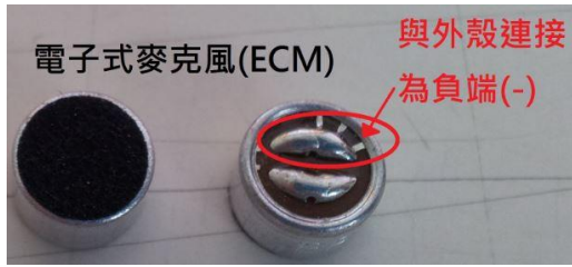
圖二之 2：電子式麥克風的正／負接腳圖
